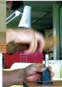
上：面取り 中：筋目付け 下：目打ち
