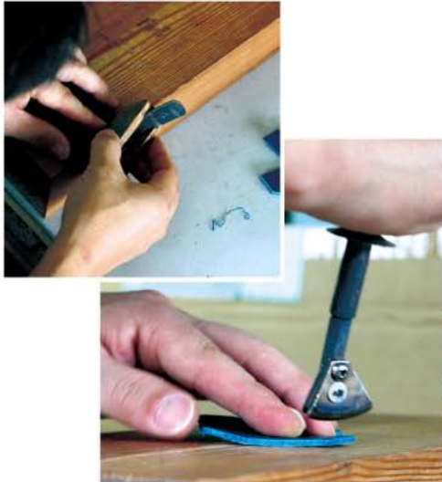
上：面取り 中：筋目付け 下：目打ち
