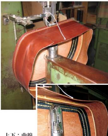
上下：曲線のある鞆のフタ部分の木枠と革の縫付け
