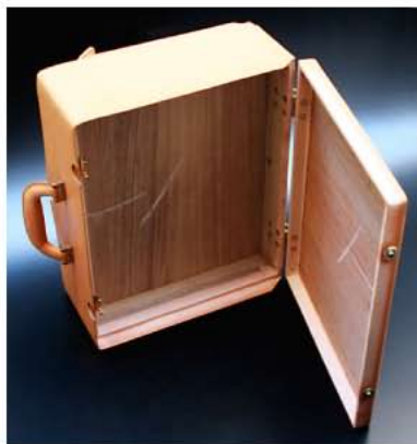
木枠に革を貼り、金具を取付けた状態。この後、内装作業をして仕上がります。
