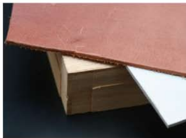
上から2mm厚のヌメ革、白いのが2mm厚のボール芯、桐の木枠。それぞれ木枠と革、ボール芯と革を重ねて一緒に縫い合わされます。
