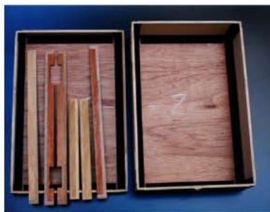
木枠のパーツ。豊岡鞆アタッシュケース・クラシックのもの。右が本体、左がフタ部分に切り分けられています。棒状の物は陰胴という密閉性を高め、フタのズレを防ぎ開口部分まわりの段差になるもの。
